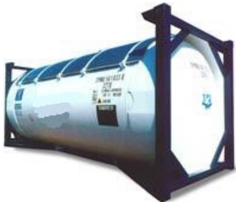
Figura 2.6 Isocontenedor de 20 ton
